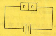
इस प्रकार की अभिनति में अवक्षय परत की चौड़ाई पर क्या प्रभाव पड़ता है? In this type of biasing, how the width of depletion layer is affected?
